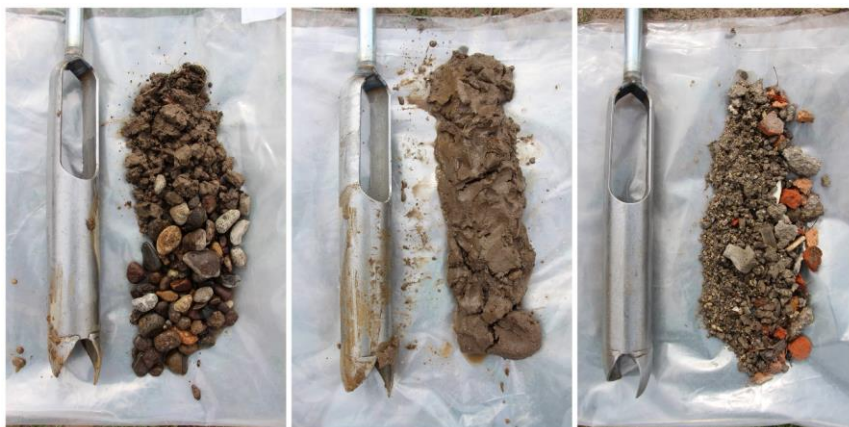
Obr. 7. Polohové zameranie a vrtanie pôdnej sondy. Vzorky pripovrchových pôdnych vrstiev sedimentov rozdielneho zloženia a genézy: vľavo) plytká hlinito-piesčitá vrstva sedimentov pokrývajúca štrkovú lavicu Kysuce s relatívne homogénnym zrnitostným zložením; uprostred) dnový bahenný sediment prevažne ílovito-hlinitého zloženia (pravdepodobne odrezané, stagnujúce vodné prostredie); vpravo) antropogénna výplň a navážka (detrit, stavebný odpad, úlomky keramiky, skla, plastov); Foto: K. Weis (2019)
