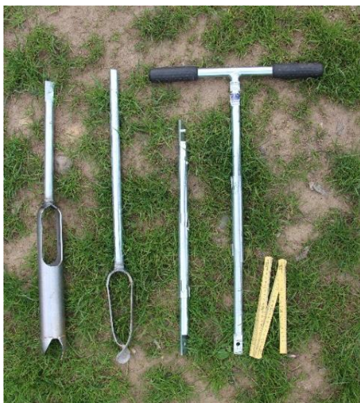
Obr. 6. Nadstavovacia pôdna sonda s hľbiacim a odberovým vŕtákom; Foto K. Weis (2019)
