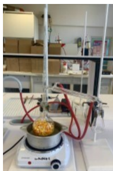
Obrázok 33. Aparatúra pre izoláciu vonných látok destiláciou s vodnou parou.
