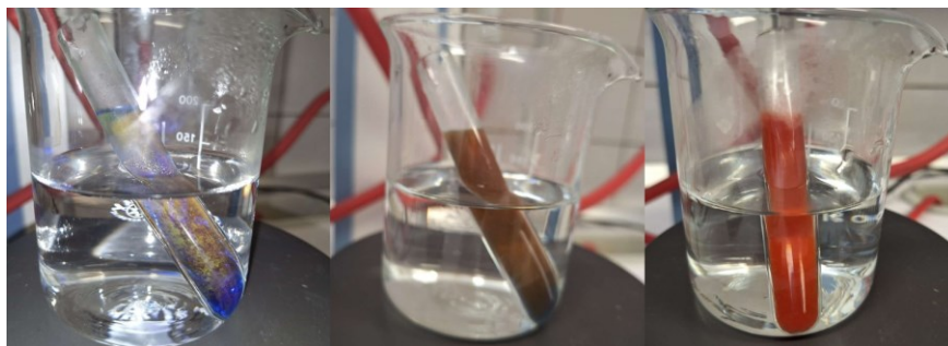
Obrázok 37. Demonštračný pokus – dôkaz redukujúcich sacharidov v mede pomocou Fehlingovho činidla - priebeh dôkazovej reakcie v čase
