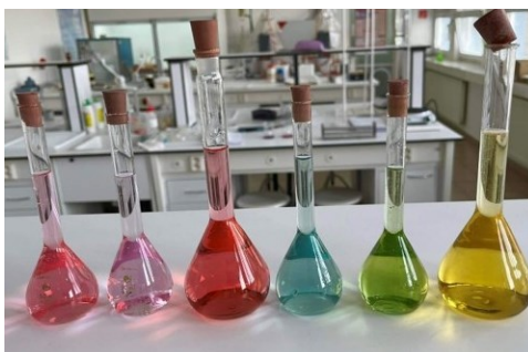
Obrázok 27. Zmena zafarbenia roztokov antokyanínov v závislosti od pH – od pH = 1 až po pH = 14 (zľava doprava)
