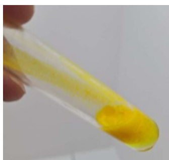
Obrázok 18. Vznik žltej zrazeniny fenyldiazónu po pridaní Bradyho činidla k roztoku formaldehydu
