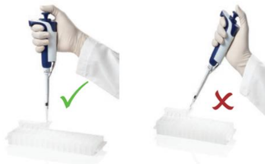
Obrázok č. 10. Príklady správneho a nesprávneho naberania kvapaliny pomocou automatickej pipety – voľba správnej hĺbky a sklonu ponorenia špičky. Červená šípka označuje koniec špičky a naznačené čísla optimálnu hĺbku pre rôzne objemy používaných špičiek.
