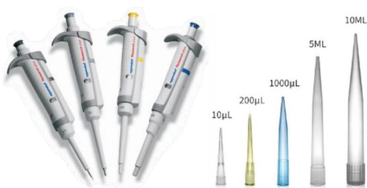
Obrázok č. 9. Farebné označenie automatických pipiet určených pre pipetovanie rôznych objemov a príslušných špičiek.
