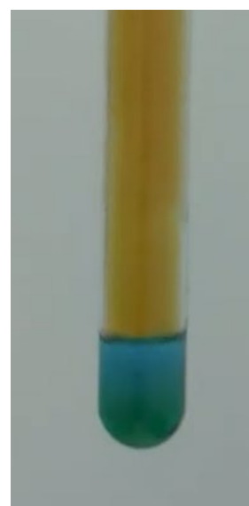
Obrázok 50 Farba roztoku dusičnanu meďnatého pri riedení vodou
