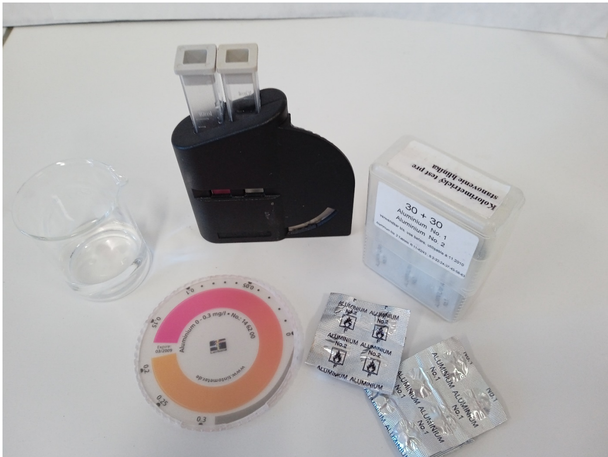
Obrázok 61 Súprava na stanovenie koncentrácie hliníka
