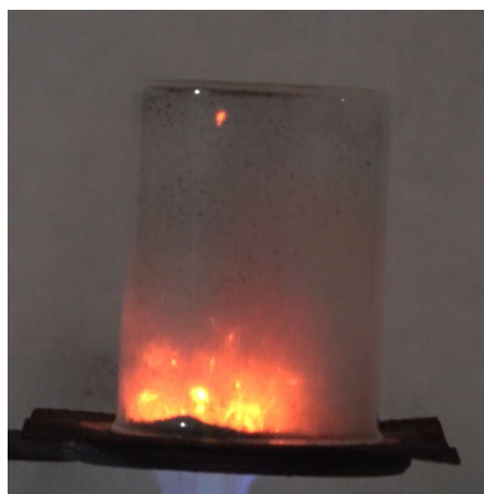
Obrázok 67 Termický rozklad dichrómanu amónneho
