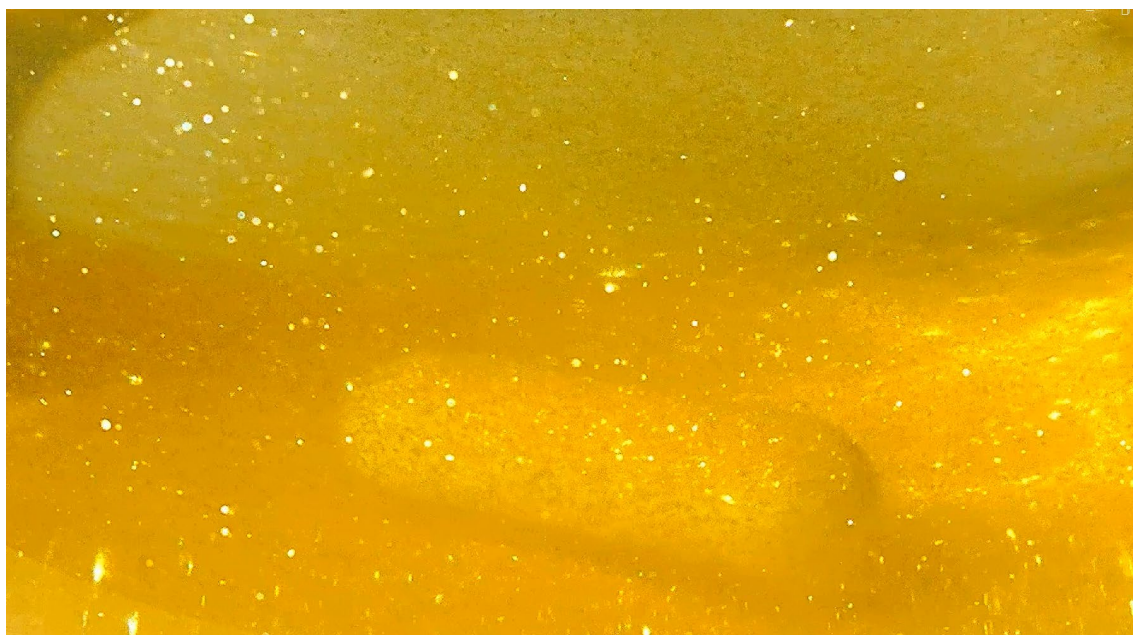
Obrázok 77 Lesknúce sa kryštáliky jodidu olovnatého podsvietené svetlom
