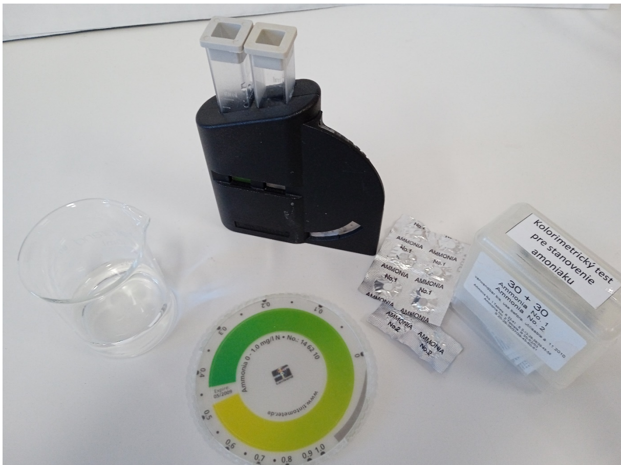
Obrázok 62 Súprava na stanovenie koncentrácie dusíka z amoniaku
