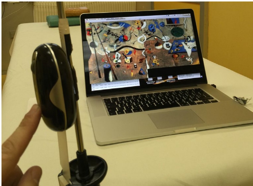
Obrázok 60 Počítačová myš ako senzor pohybu nohy pacienta. Rehabilitačná pomôcka pre pacientov po mozgovej mŕtvi a operácii kĺbov. CIKE / FNLP
