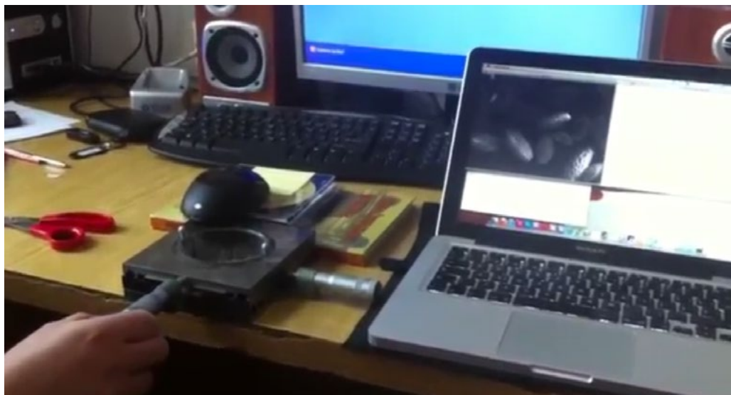
Obrázok 59 Počítačová myš ako senzor pohybu - kalibrácia posunu pre exponát elektónový mikroskop „STEELPARK“ vedecký park pre mládež.
