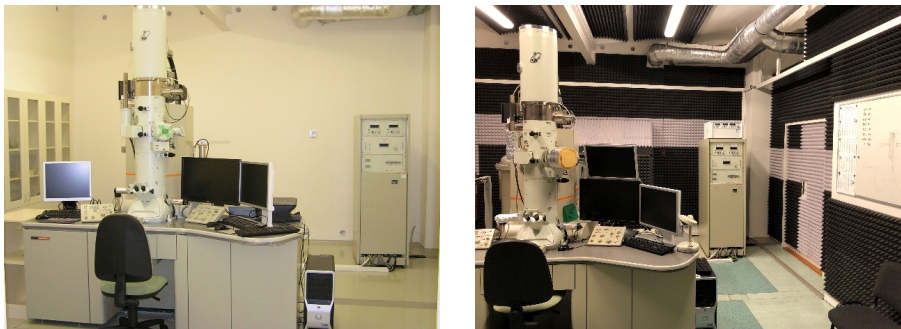
Obr. 1: Laboratórium SLTEM pred inštaláciou akustickej peny (vľavo) a po inštalácii (vpravo).
