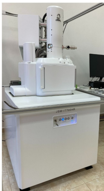
Obr. 1: Obrázok naľavo - skenovací elektrónový mikroskop JEOL JSM-IT700HR. Obrázok napravo - pohľad do komory mikroskopu.
