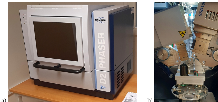
Obr. 1: a) Kompaktný (stolný) práškový difraktometer D2-Phaser Bruker. b) Detailný pohľad na Bragg-Brentano goniometer s automatickým meničom vzoriek (6 pozícií).
