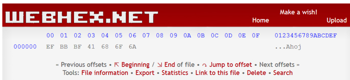
Obrázok 77. Obsah textového súboru obsahujúci text „Ahoj“ uloženého v kódovaní UTF-8 zobrazený v online hex prehliadači webhex.net.
