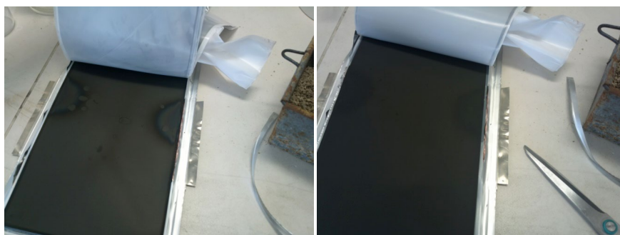
Obr. 1. Batéria od firmy Enerdel: anódový materiál (vľavo) katódový materiál (vpravo).
