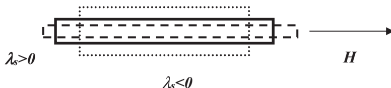
Obr. 2.4: V závislosti od charakteru magnetostríckie sa magnetický materiál (zobrazený neprerušovanou čiarou) predlžuje (v prípade kladnej magnetostríckie – prerušovaná čiara), resp. skracuje (v prípade zápornej magnetostríckie – bodkovaná čiara) v smere aplikovaného magnetického poľa H .
